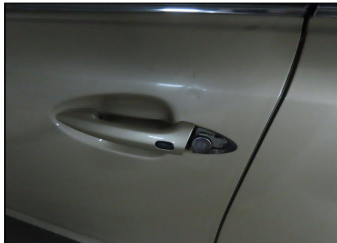
Udubljenje vrata vozača i nedostaje pokrov cilindra brave
